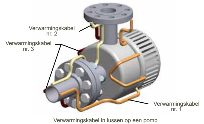
Afbeelding H: Voorbeeld pompdetail
