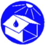
Die Heizplatten sind für den Betrieb in geschlossenen Räumen und überdachten Außenbereichen geeignet (Schutzart IP 65). Sie dürfen nicht der Witterung dauerhaft ausgesetzt werden.
